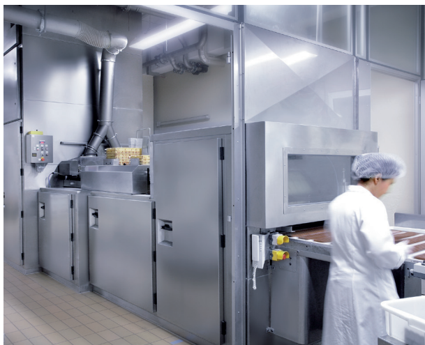
Die Verkleidung schirmt die Produktionsstraße sicher zum Umfeld ab und gewährleistet einen effizienteren Energieeinsatz sowie geringe Geräuschemissionen während der Produktion
